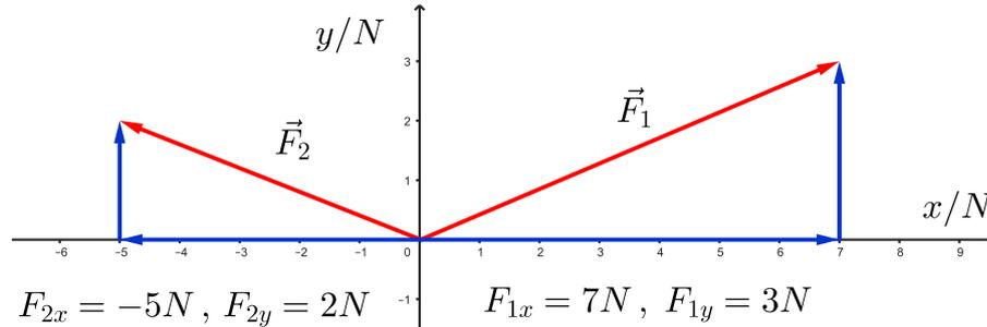
Abbildung 2: Beispiele zur orthogonalen Kraftzerlegung
