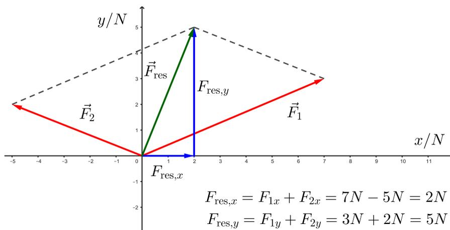
Abbildung 4: Beispiel zur Konstruktion der resultierenden Kraft
