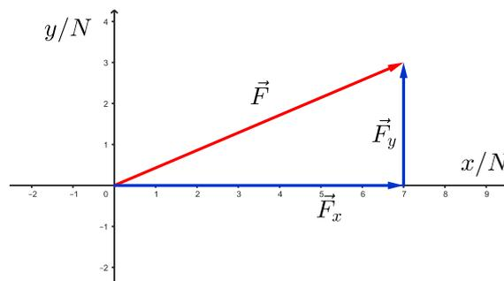
Abbildung 1: Die orthogonale Kraftzerlegung im  $xy$ -Koordinatensystem
