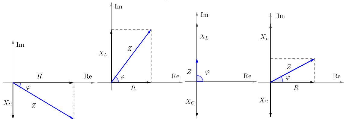
Die Zeigerbilder der Parallelschaltungen nutzen statt der Widerstandswerte  $\underline{Z}$  deren Kehrwerte  $\frac{1}{\underline{Z}}$ .
