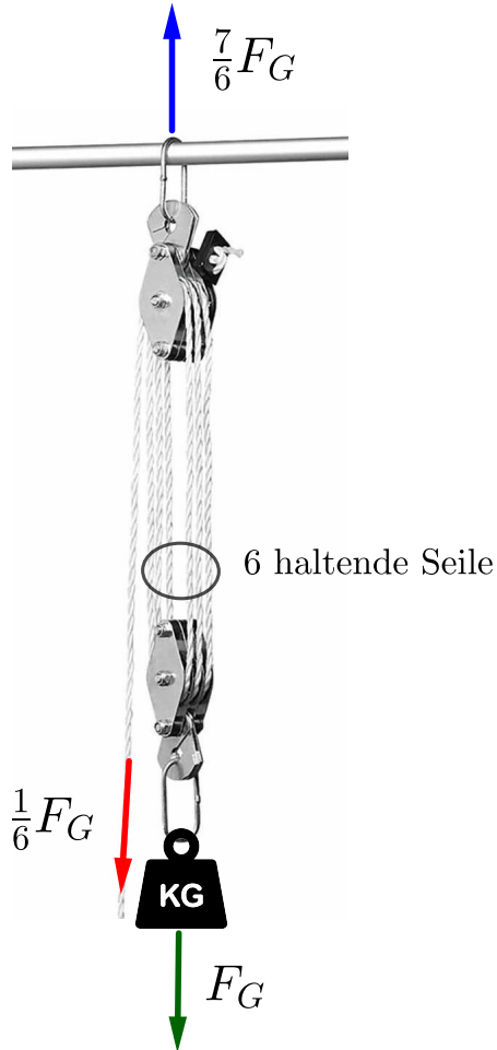
Abb. 6: Praktische Umsetzung eines Flaschenzugs gemäß Abb. 2
