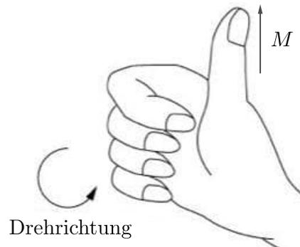
Abbildung 5: Die Rechte-Faust-Regel zur Bestimmung der Drehrichtung
