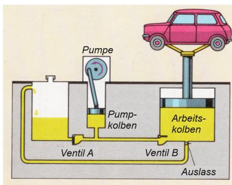
Abb. 1b: Hydraulische Presse
