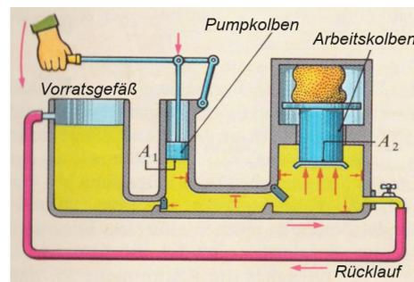
Abb. 1c: Reduzierte Funktionsweise
